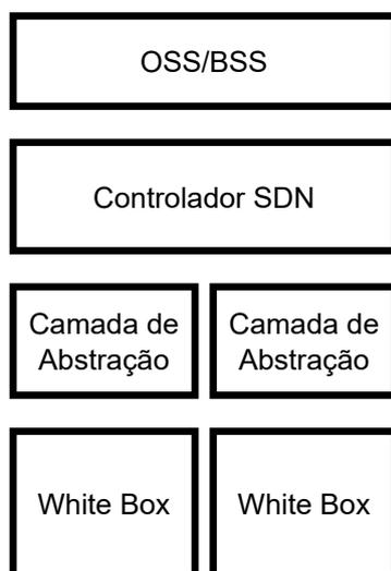
Figura 48 – Arquitetura de aplicação FTTx aberta e desagregada.
