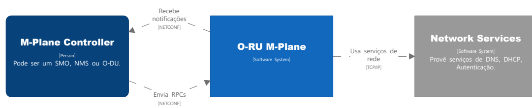
Figura 4 - Diagrama de contexto ilustrando a interação do M-Plane com elementos externos.
