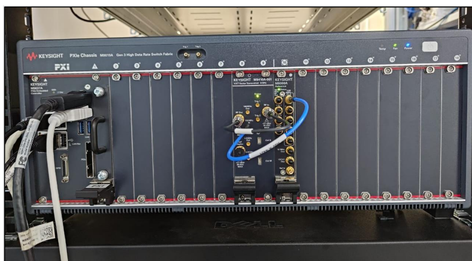
Figura 35 - Chassi PXI com módulo RF conectado em loopback
