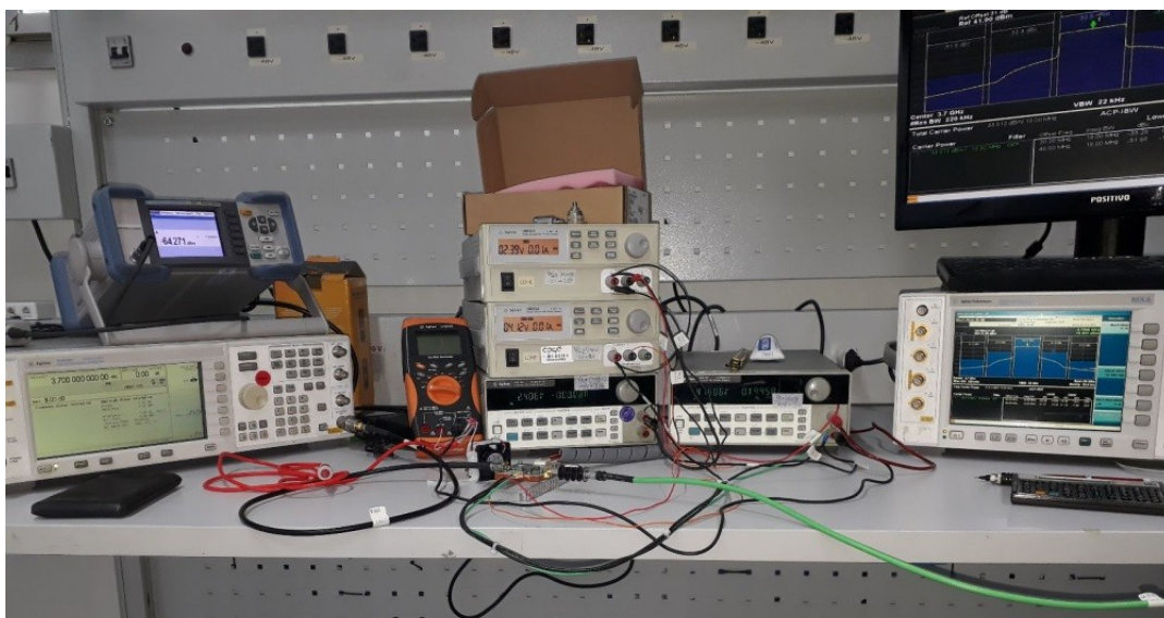
Figura 22 - Arranjo experimental para avaliação espectral e da potência de saída da EVB QPA3810.
