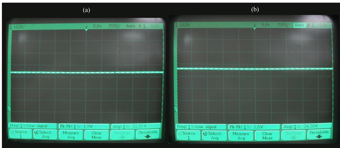
Figura 18: (a) Sinal medido na saída do LDO; (b) Sinal medido na saída sem o LDO.
