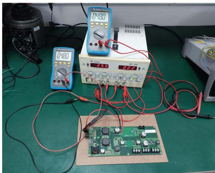
Figura 22: *Setup* de teste do *surge stopper*.
